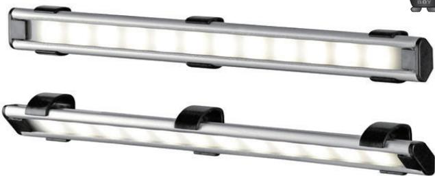
保護特性 IP67 のラインライト。付属の取付ステーで正面取付けや45°斜め取付けができます。明るさむらの少ない乳白レンズで長さは290mm、540mm、800mmの3種類あります。
