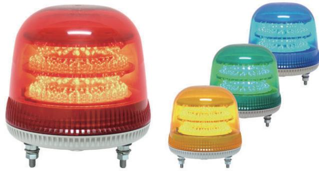
2 段の鏡面上に 160 個の LED を配することにより滑らかな回転を実現した大型 LED 回転灯です。点滅、回転速度（低速・高速）の切り替えができ、警告音&メロディ付きではそれぞれ 2 種類の電子音での出力ができます。
